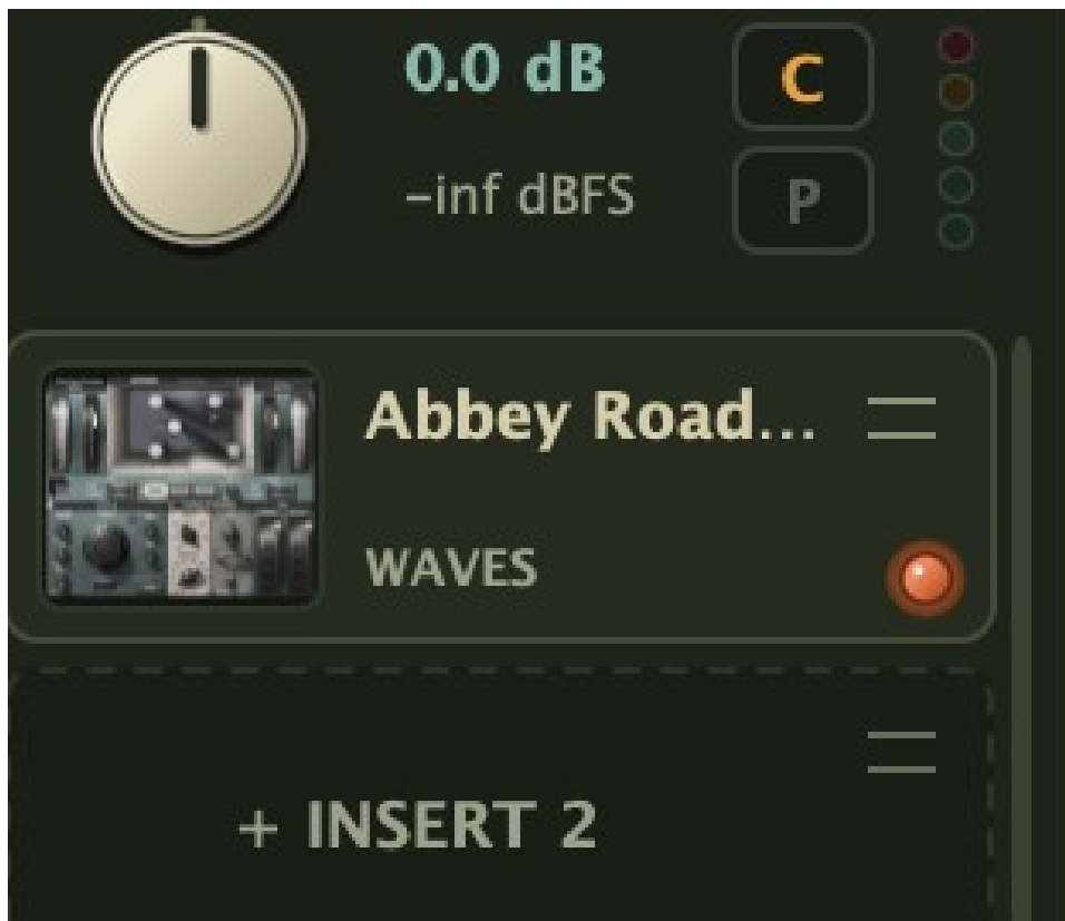
รูปที่ 3B: ภาพขยายเจาะลึกช่อง Insert Slot 1 แสดงภาพย่อ, ชื่อผู้ผลิต, ปุ่มลากย้าย และไฟบอก Latency สัม
